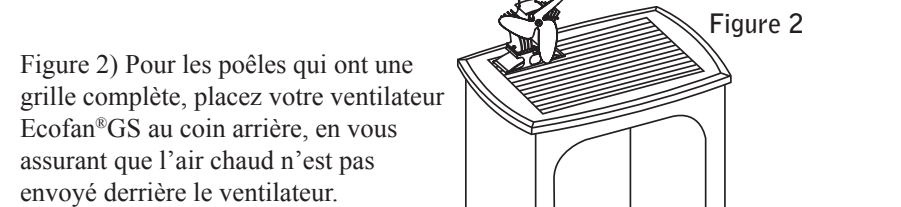
Figure 2) Pour les poêles qui ont une grille complète, placez votre ventilateur Ecofan®GS au coin arrière, en vous assurant que l'air chaud n'est pas envoyé derrière le ventilateur.
